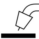
Un arc fait fondre le fil alimenté en continu. Le bain de soudage est protégé par un gaz inerte.
