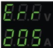
L'exemple présenté dans le graphique de gauche, indique que l'anomalie de tension d'alimentation est dans la source d'alimentation.
